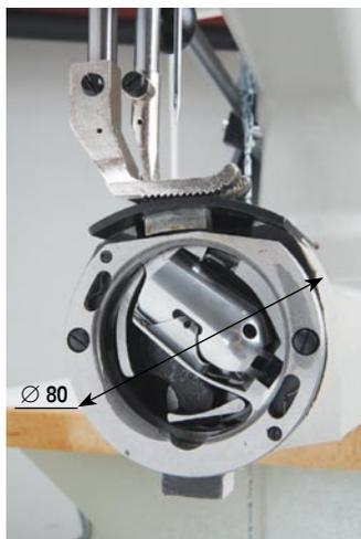
Barelový chapač zajišťuje dostatečnou zásobu silných nití. Průměr ramene 80 mm umožňuje šítí malých rádiusů.
