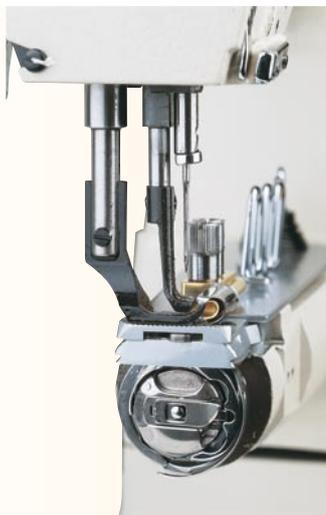
Horizontálně uložený velkopřůměrový chapač.
