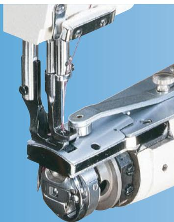
Stroje jsou vybaveny velkopřůměrovým horizontálně uloženým čapačem s cívkou o průměru 26 mm. Vodičí pravitko s rolničkou lze doobjednat jako vybavení.
